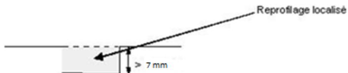
d) discontinuité de niveau + dépose d'une cloison
