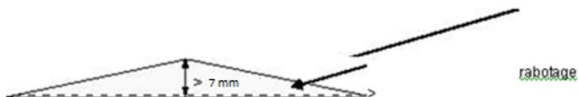
La largeur de reprofilage doit être calculé de manière à respecter la planéité de 7 mm sous la règle de 2 m.
